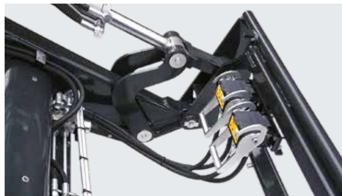
Do jeszcze szybszego połączenia przewodów hydraulicznych złącze Hydro-Fix jest dostępne również do montażu osprzętu.
