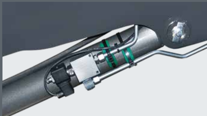
Zabezpieczenie przed opadnięciem
