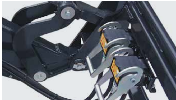
Osprzęt Fix Złącze podwójne do 3. i 4. obwodu sterowniczego.
