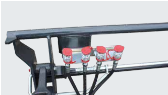
3. i 4. obwód sterowniczy (tutaj w postaci złącza wtykowego) Do łatwej obsługi osprzętu hydraulicznego, np. wycinaka do kiszunki, chwytaka balotów lub sztaplarki do balotów.
